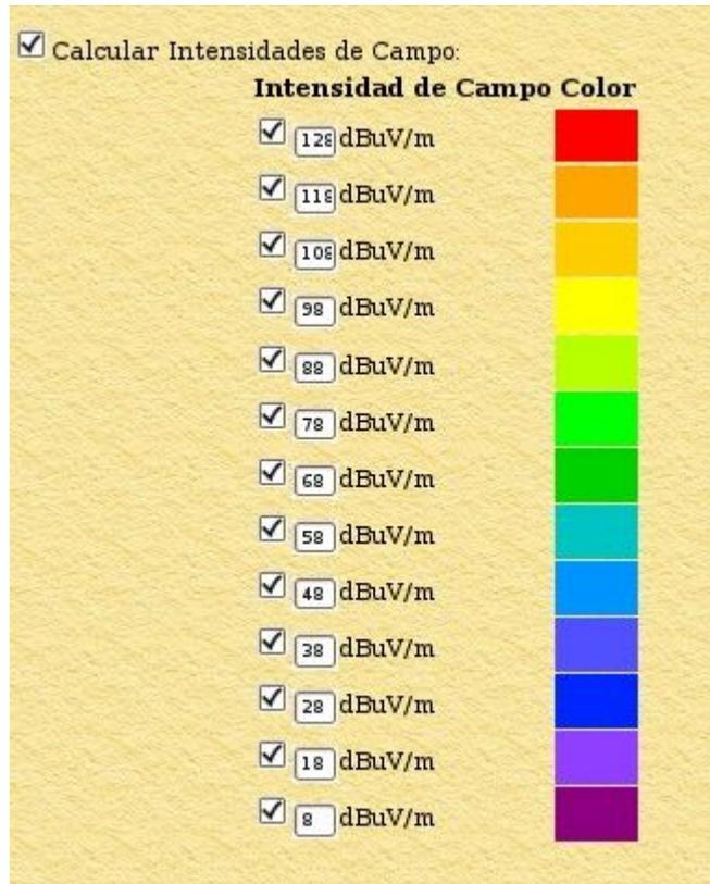
por ejemplo para la legislación ecuatoriana vigente al año 2012, para las estaciones de FM de potencia normal se requiere realizar la predicción de cobertura para las zonas principal y secundaria delimitadas por intensidades de campo de 54 dBuV/m y 30 dBuV/m respectivamente.
